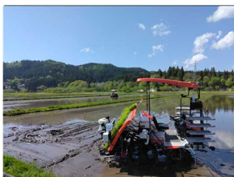
ロボット田植機による自動旋回
