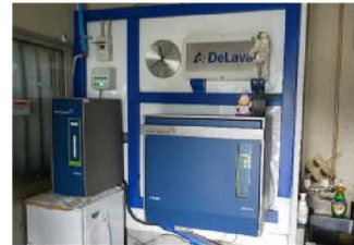
隣接するサンプルインテークユニット(左)と分析ユニット(右)
