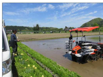
リモコン操作による田植機移動
