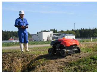
ラジコン草刈り機による除草作業
