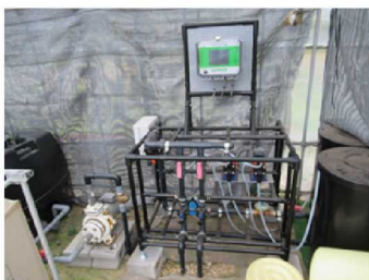
養水分の自動供給装置
